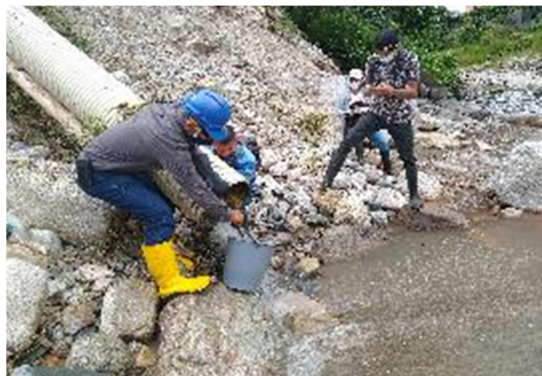
Ilustración 40. Aforos puntos de vertimiento. Fuente Aguas Mocoa S.A. E.S.P.
